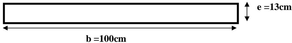
Figure III.10. Section de la dalle pleine à ferrailer.
