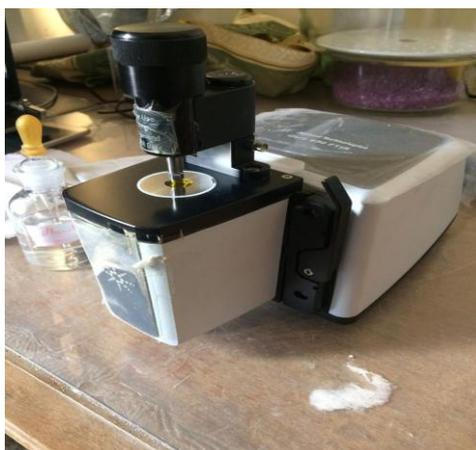
**Figure II.6 :** Spectromètre *Cary 630 FTIR*
