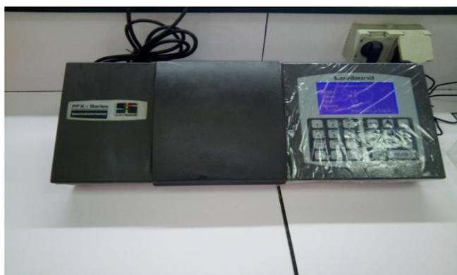
**Figure II.3 :** Colorimètre électronique « Lovibond ».
