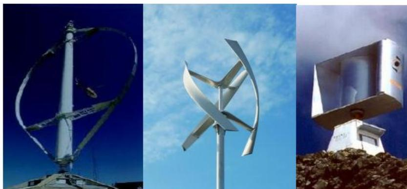
**Figure I.5:** Eolienne à axe verticale [6]
