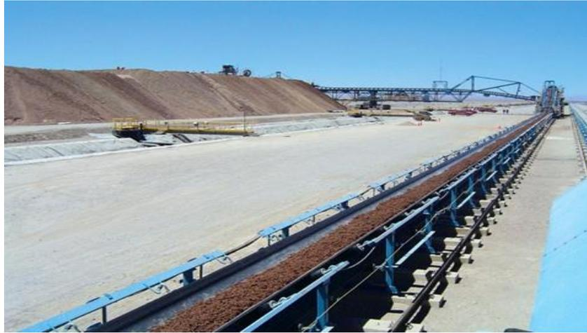
**Figure I.13.** Convoyeur à bandes
