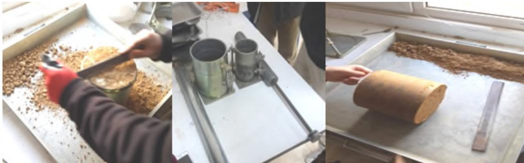
*Figure (V.3):Essai Proctor réalisé au laboratoire*
