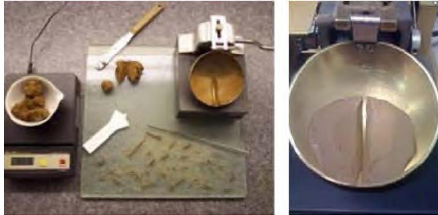
Figure (V.2):Appareil de CASAGRANDE
