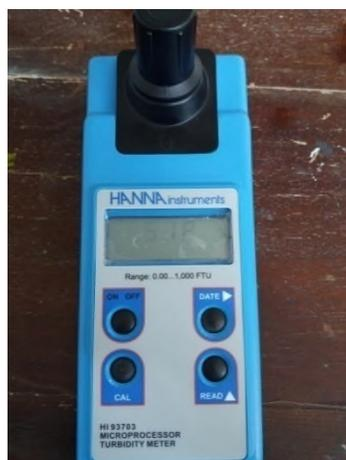
*Figure (V.9):Appareil de mesure de la turbidit *
