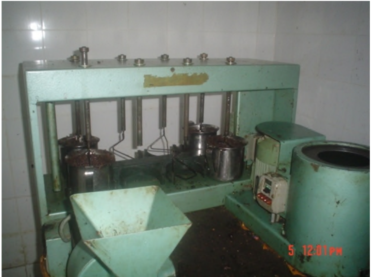
Figure 13 :Photographie d'un Oléodoseur
