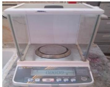
**Figure (16) :** Photographie de la balance analytique.
