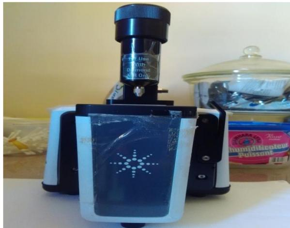
**Figure 15:** l'appareil Agilent Technologies Cary 630 FTIR pour l'analyse IRFT
