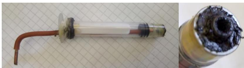
Figure V.3 : Photos d'une électrode de travail et vue de sa surface
