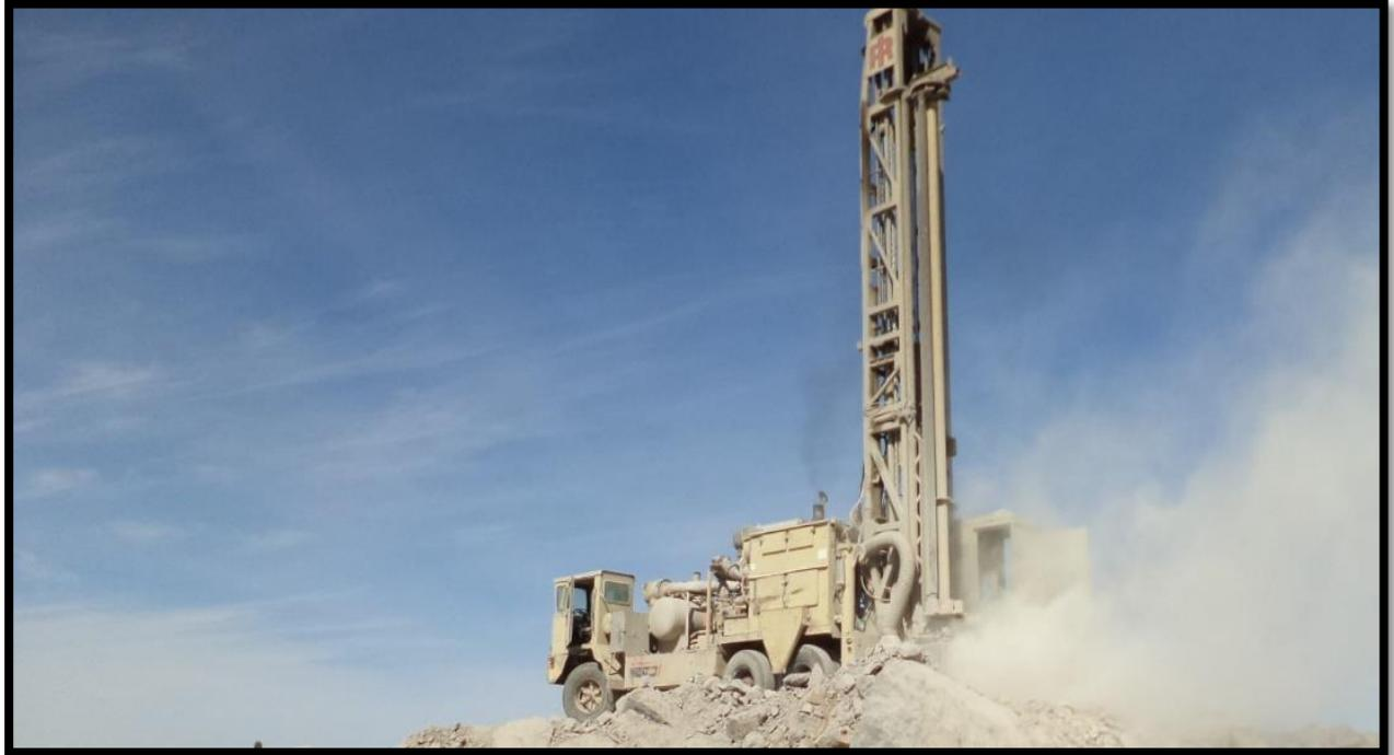
**Figure II.1** : sondeuse de type I-RAND I4BH. [1]
