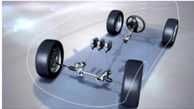
Fig.06 Illustration du système de direction d'une voiture
