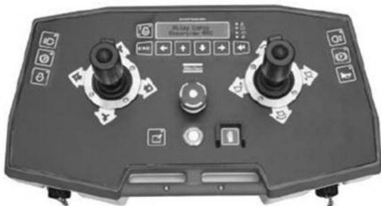
Fig.30 Télécommande radio pour équipement minier
