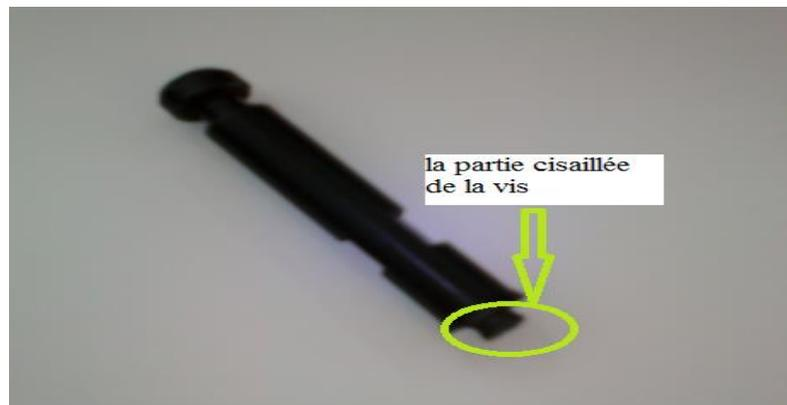
**Figure III.1** : La vis de fixation
