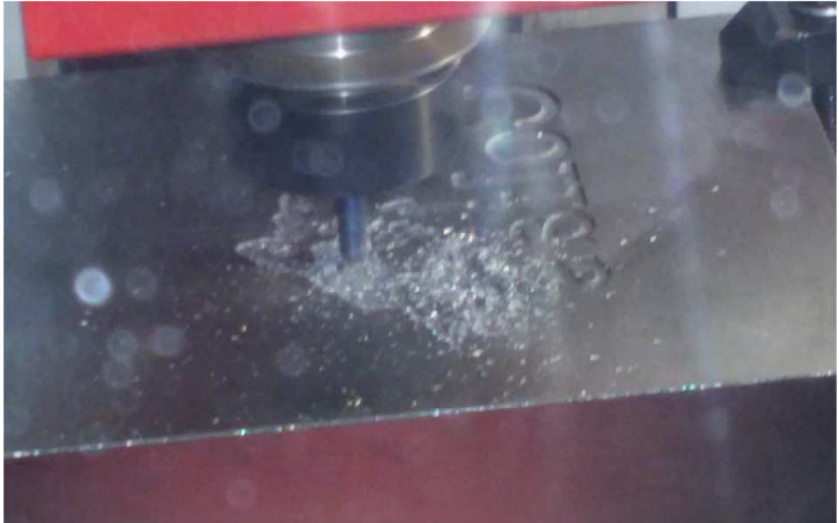
Fig. IV.13. Notre plaque lors d'usinage de l'empreinte
