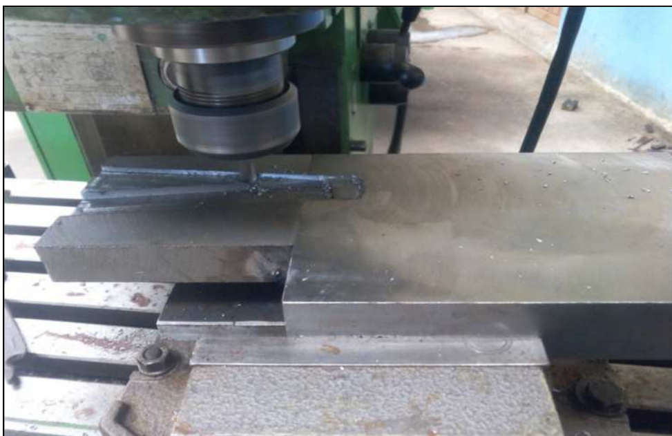
Fig. IV.12. Notre plaque après l'usinage de rainure
