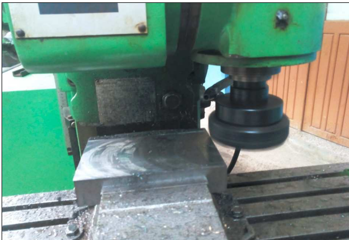
Fig. IV.9.Surfaçage de la pièce
