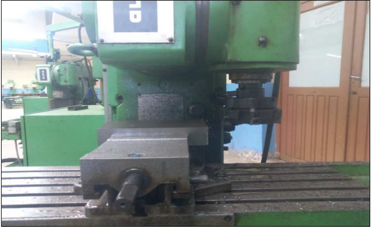
Fig. IV.8. Fixation de la pièce
