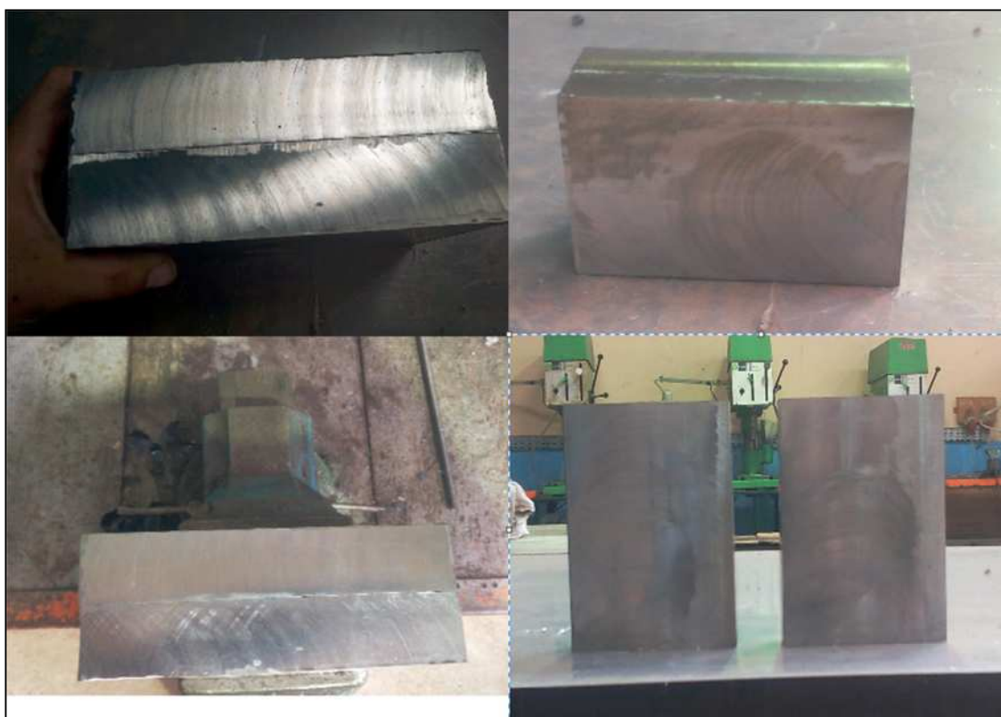
Fig. IV.10.Finition du bloc de moule
