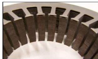
Stator feuilleté sans les bobinages
