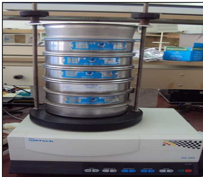
Photo III.1: Un tamiseur électrique à vibration horizontale et verticale et les séries des tamis suivant la norme « AFNOR ».
