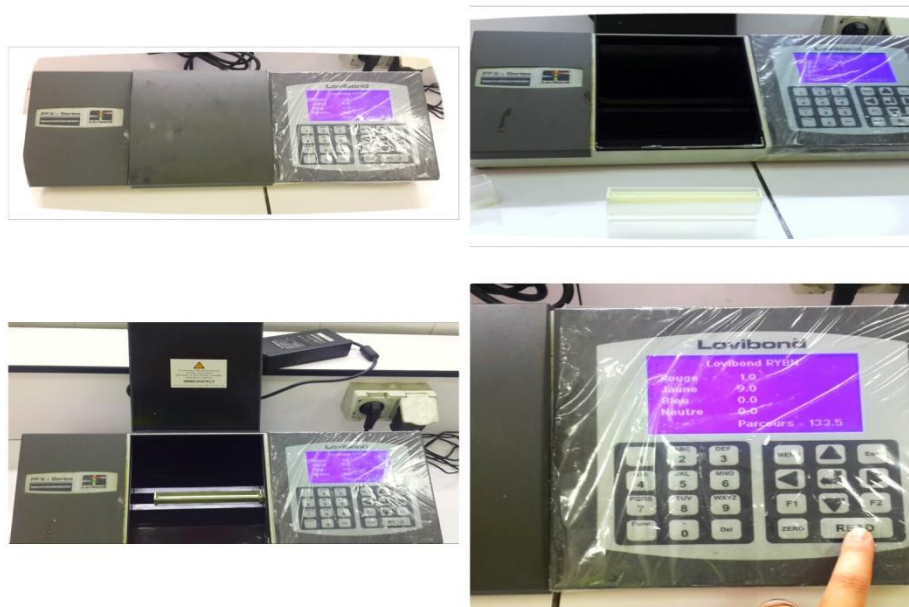
Figure N°1 : Etapes d'utilisation d'un LOVIBOND.
