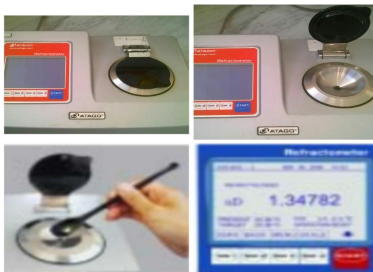
Figure N°3 : Mode d'utilisation d'un réfractomètre numérique de paillasse.
