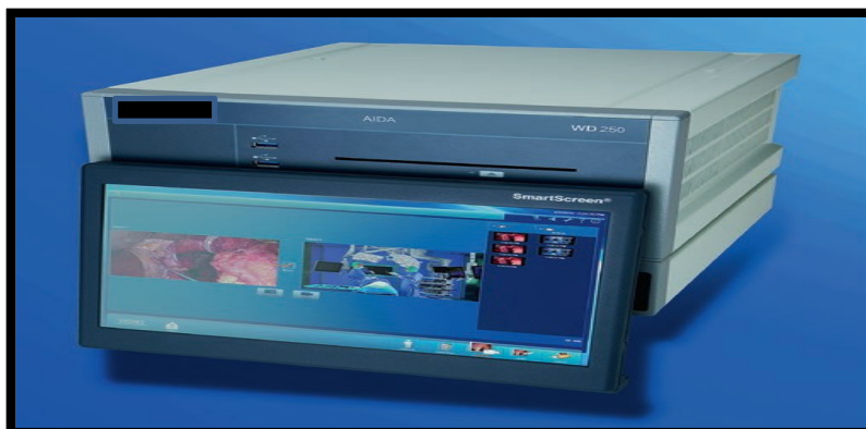
Figure 44 : Système AIDA (Advanced Image and Data Acquisition) pour l'enregistrement des données du patient, des vidéos full HD ( Atlas of neuroendoscopic neurosurgery of the third ventricle )
