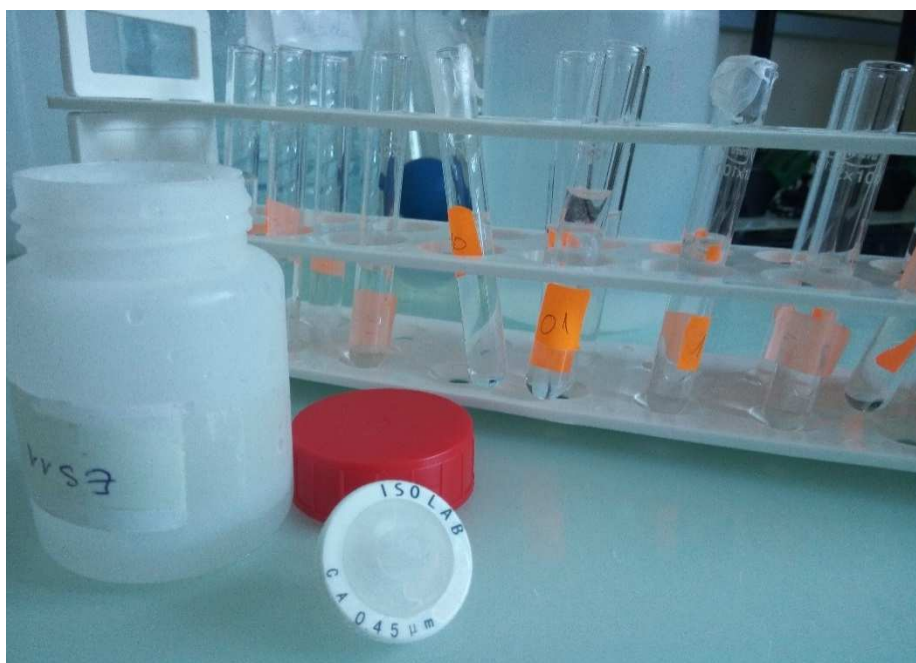
Figure II.4 : Echantillon acidifié et filtre à seringue et tubes à essais utilisés pour la préparation des échantillons
