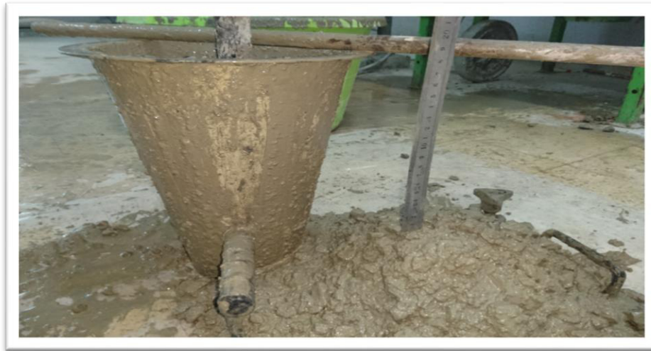
Figure II.13 : Essai d'affaissement au cône d'ABRAMS.
