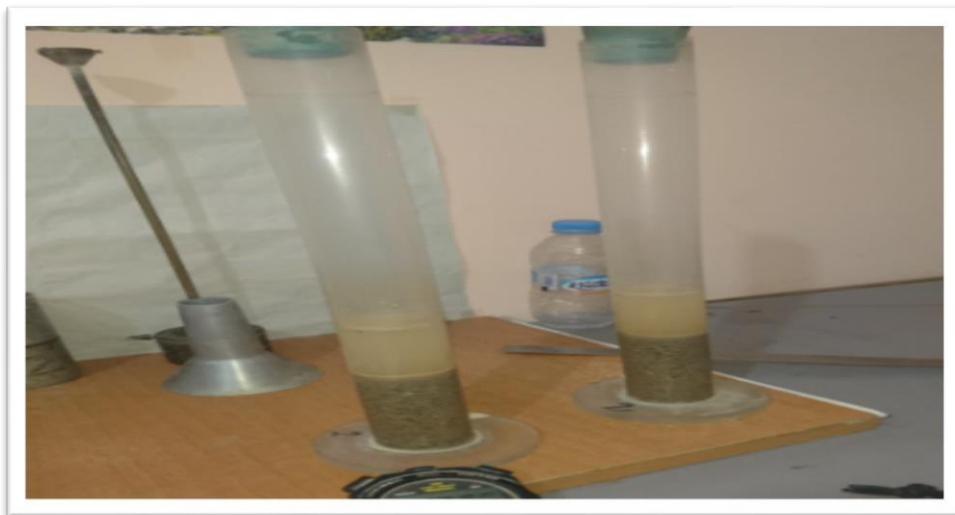
Figure II.7. Essai d'équivalent de sable.
