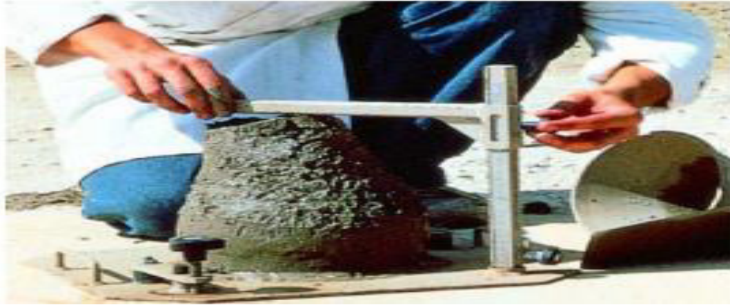
Figure I.4. Mesure de l'affaissement [36].
