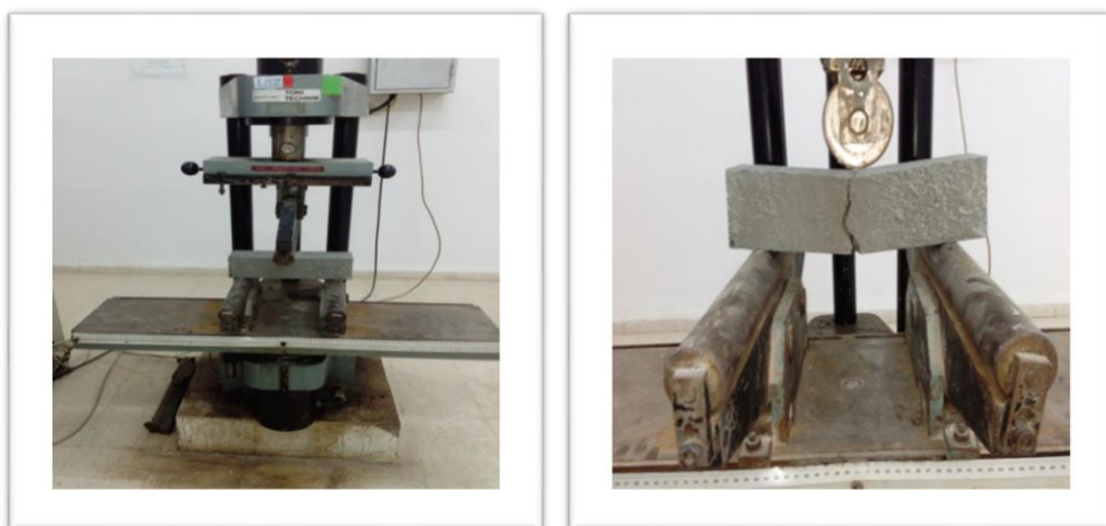
Figure II.16. Essai de flexion. (Photo prise au laboratoire CETIM, Boumerdes Avril 2018).
