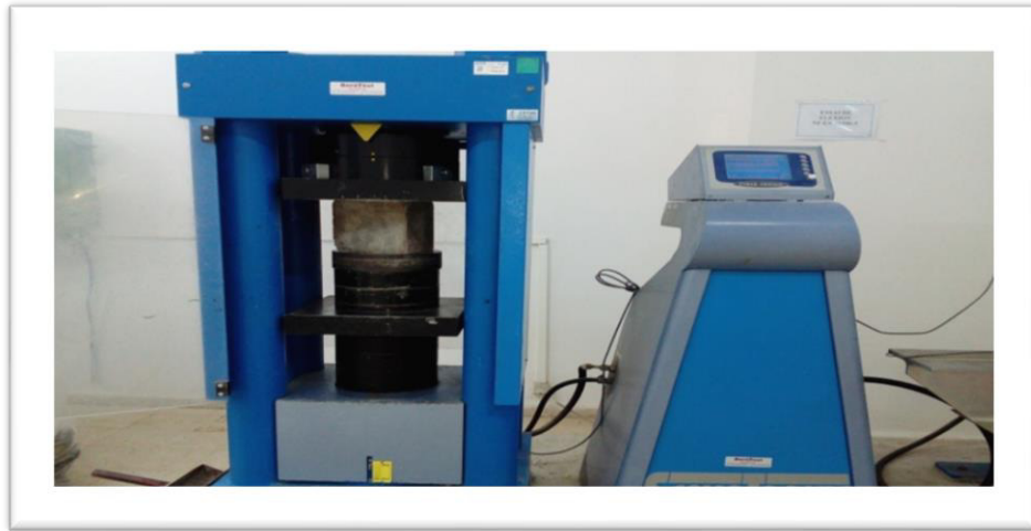
Figure II.15 : Machine pour essai de compression. (Photo prise au laboratoire CETIM, Boumerdes Avril 2018).
