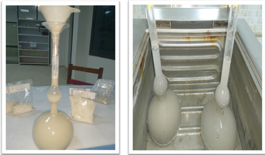
Figure II.4 : Essai le chatelier. (Photo prise au laboratoire CETIM, Boumerdes Avril 2018).
