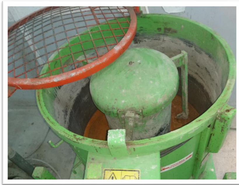
Figure II.12 : Malaxeur pour la confection du béton (Photo prise au laboratoire CETIM, Boumerdes Avril 2018).
