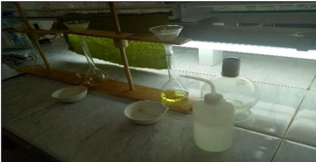
**Figure II.10:** Filtration de solution
