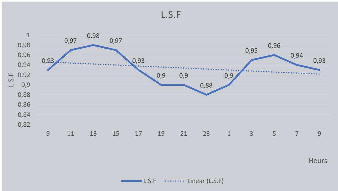
**Figure III.2.** Fluctuations des valeurs du Facteur de saturation en chaux (L.S.F) des crus conçus pendant 24H.
