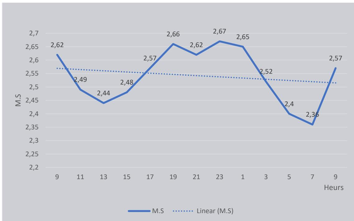
**Figure III.1.** Evolution du module silicique (M.S) des crus conçus pendant 24H.
