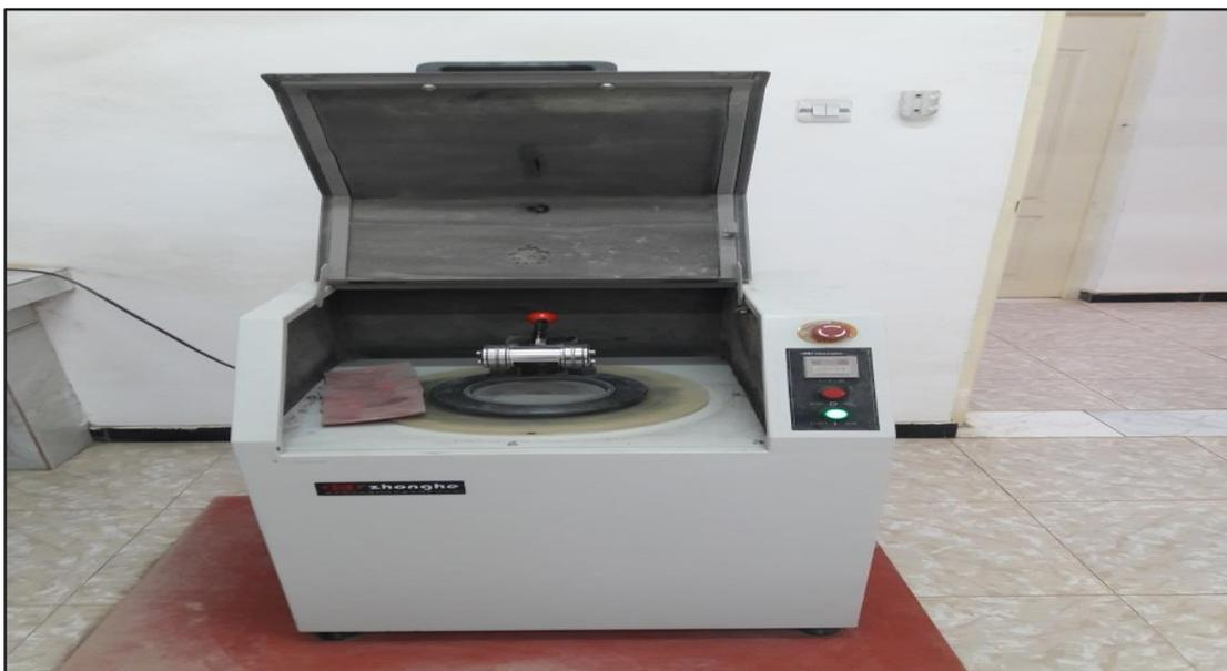
**Figure II.4:** Broyeur à disque disponible à la cimenterie de Sidi Moussa-ADRAR.
