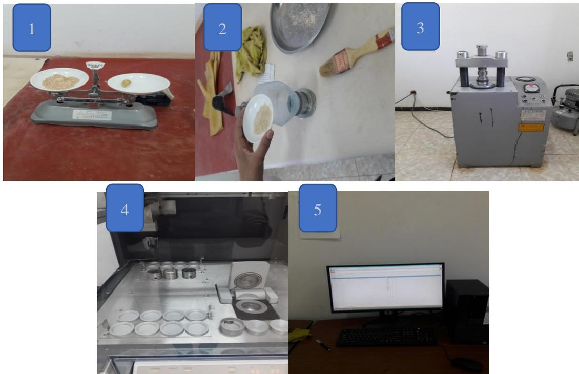
**Figure II.6:** Les étapes d'analyse par spectromètre de fluorescence des rayons X.
