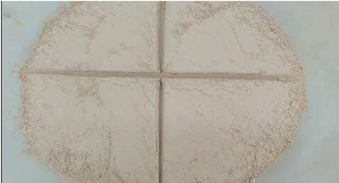
**Figure II.5:** Exemple de quartage d'un calcaire.
