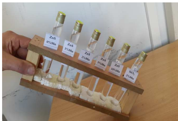
Figure II.12 : Photographie montrant les solutions finales transparentes et homogènes dans les tubes à essais.
