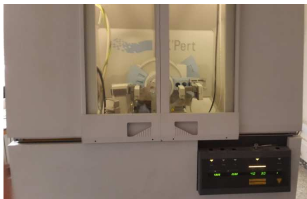
Figure II.9 : Photographie montrant le diffractomètre de type Panalytical Expert Pro.
