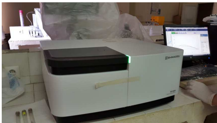
Figure II.11 : Photographie montrant le spectrophotomètre utilisé.
