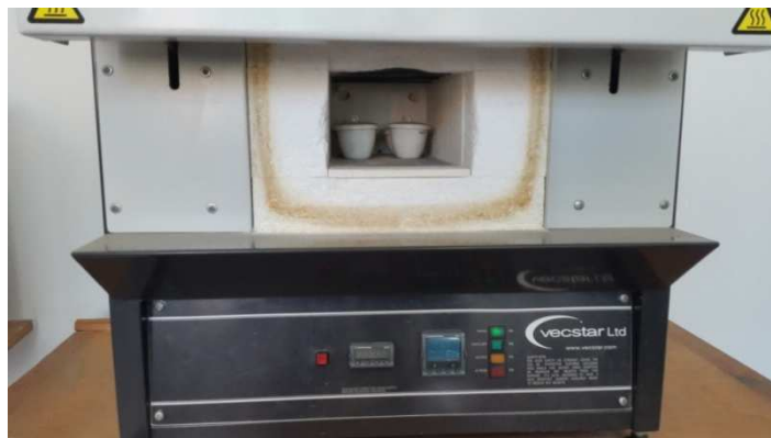
Figure II.16 : Photographie des poudres blanches dans un four pour le traitement thermique.
