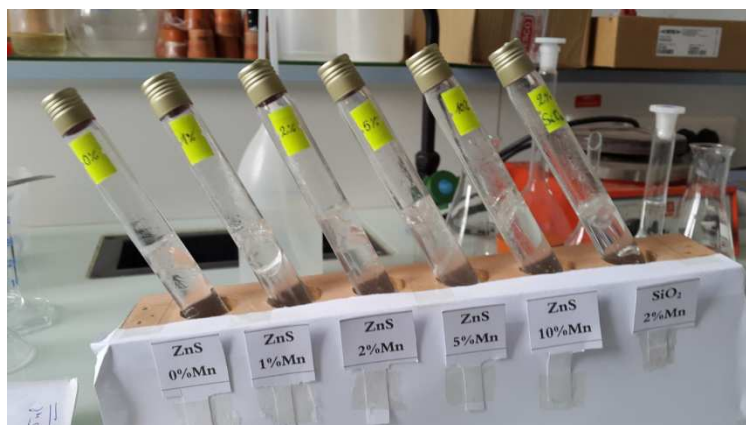
Figure II.14 : Photographie des solutions finales dans les tubes à essais après gélification.
