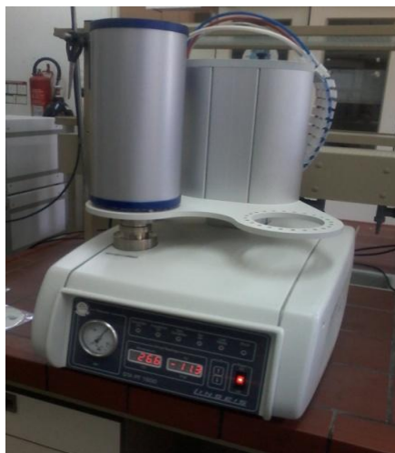
Figure II-15 La machine des analyse thermogravimétrique (ATG) de type LINSEIS STA PT 1600.
