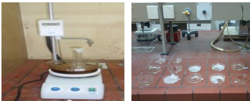
Figure II-12 Dispositif de la solvatisation pour préparer des Films.
