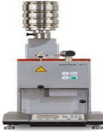
Figure II-18 Fluidimètre de type Zwick –Mflow.
