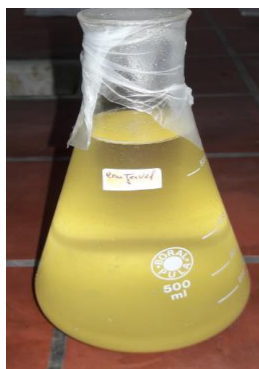
Figure II-8 Blanchiment de la MCC dans la solution dilué avec de l'eau Javel.
