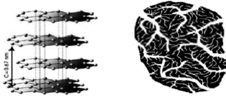
Figure II.1: Structure chimique du charbon actif et représentation schématique de sa structure [32].
