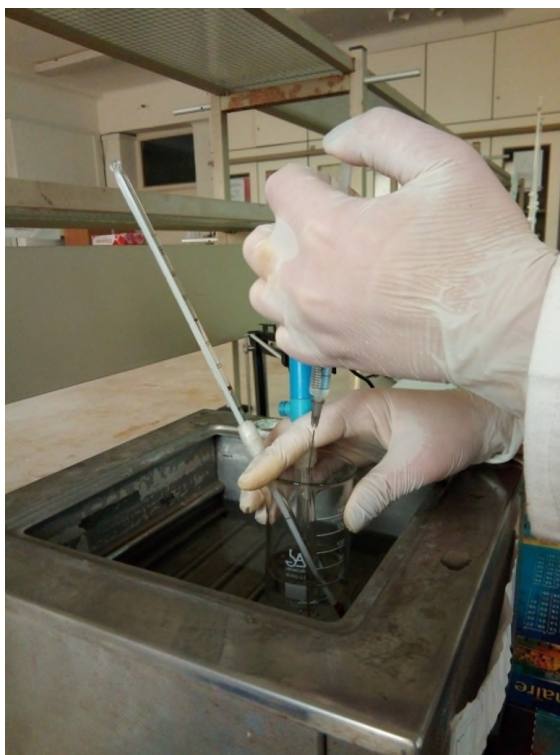
Figure B.2. Photo du dispositif expérimental de la technique du pH critique
