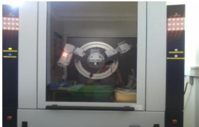
Figure II.17 : Diffractomètre des rayons X.
