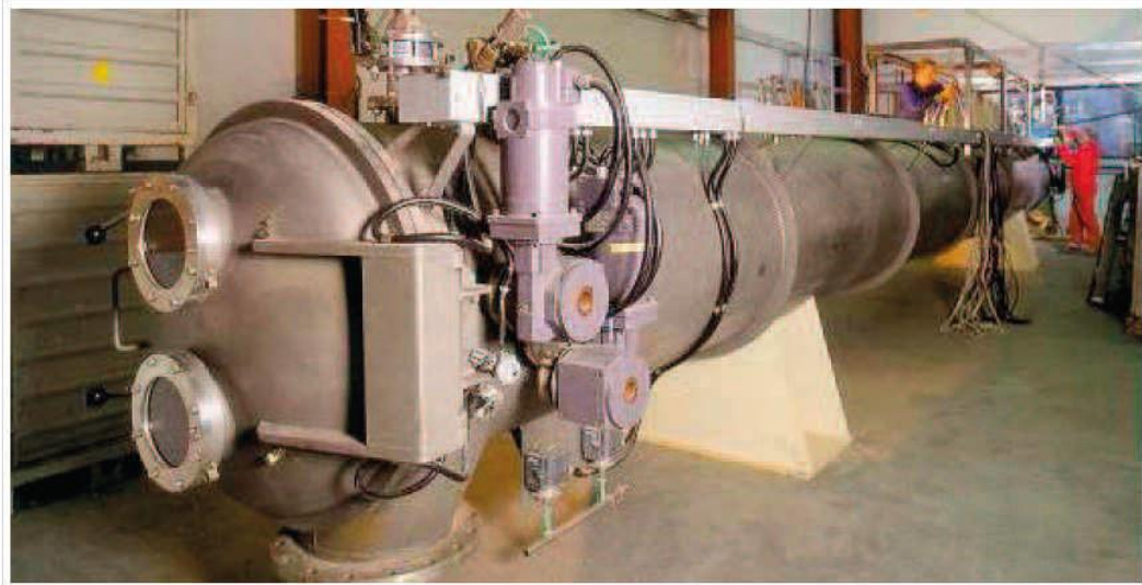
Figure 07: Séchage des fruits tropicaux sous vide assisté par micro-onde [40]
