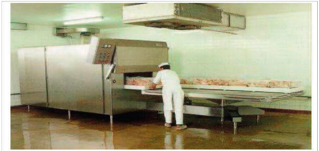
Figure 08 : Décongélation de viandes et poissons assistée par micro-ondes [36]
