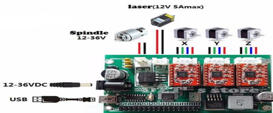
Figure I.14 : exemple d'une carte de commande
