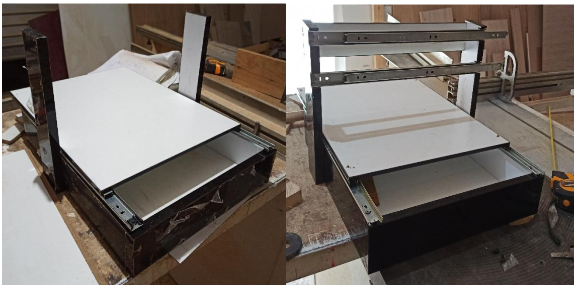
Figure IV.1 : châssis de la machine en MDF
