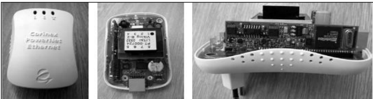
Figure I.8 : Extérieur et intérieur d'un modem PLC Home-Plug Corinex Power Net.
