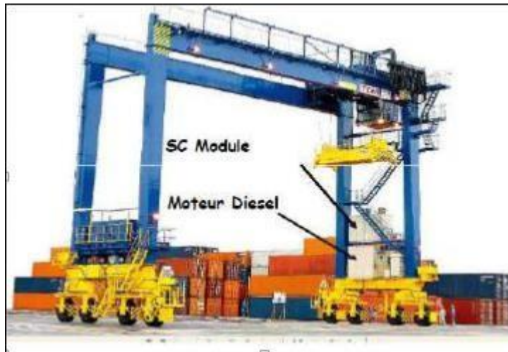
Figure I.8: Grues aéroportuaires au Japon combinant un moteur diesel et des modules Supercondensateurs [12].
