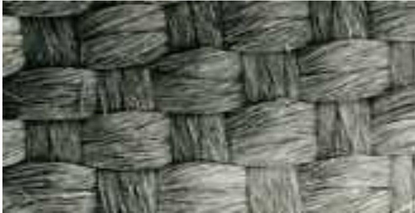
Figure I.4 : Structure microscopique d'une électrode en tissu activé
