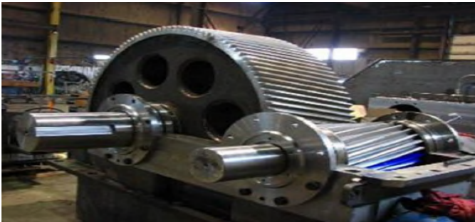
Figure II.8 : Structure générale du réducteur à arbres parallèles.
