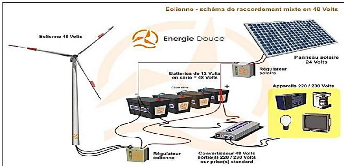
Figure I.7 Systèmes d'alimentation autonome hybride Photovoltaïque
