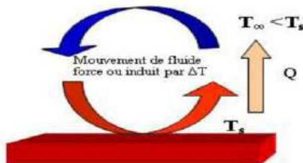
Figure I.5: Schéma du phénomène de transfert de chaleur par convection. [5]
