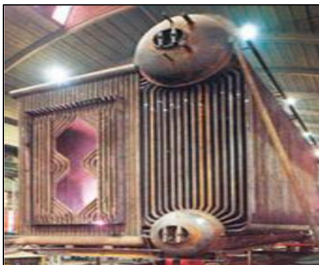
Figure I.4 : Chaudière à tubes d'eau. [3]
