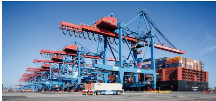
Figure 1.8 : Exemple d'un portique.
