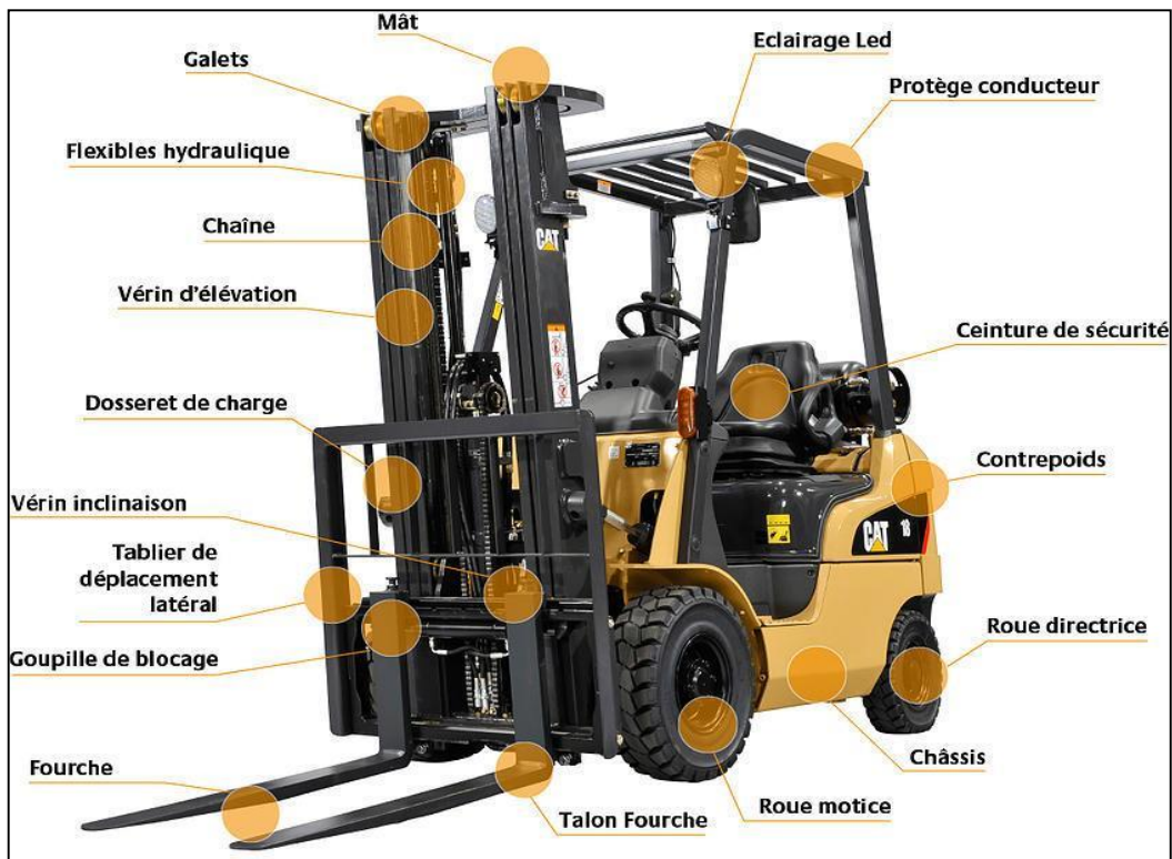
Figure II.1. : Les différents éléments d'un chariot élévateur.
