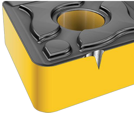
Figure II.22 : Usure en entaille [17].
