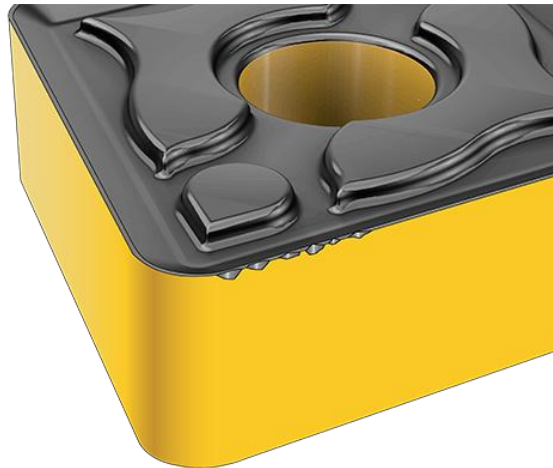
Figure II.23 : Usure par écaillage [17].
