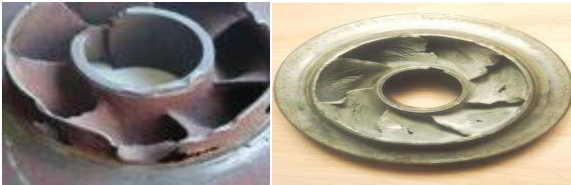
Figure I.12: Roues endommagées par le phénomène de la cavitation. [7]
