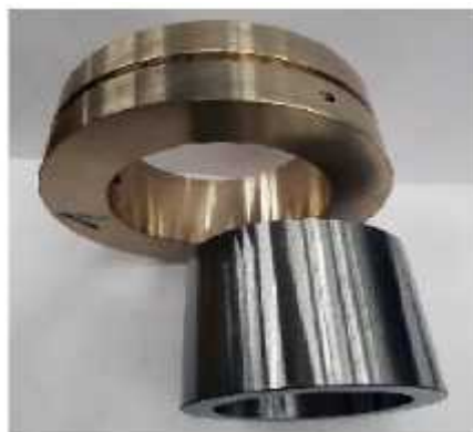
Figure 4 : Photographie du coussinet et de tourillon avec des surfaces non texturées.
