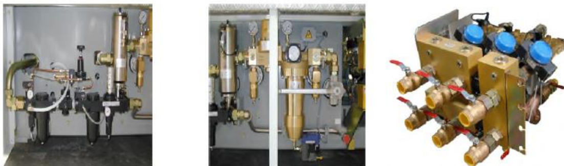
Figure I. 11 Les tableaux de fluides de la souffleuse SBO4 [1]
