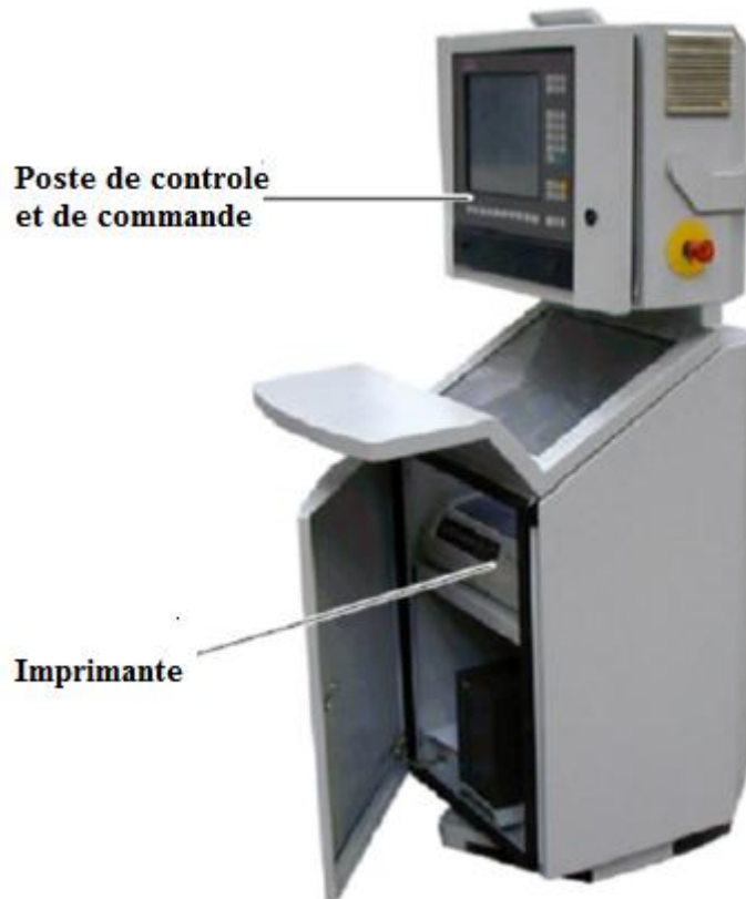
Figure I. 12 Le poste de contrôle et de commande (p.c.c) de la souffleuse SBO4[1]
