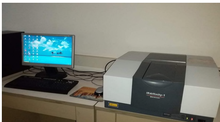
Figure II.2: Photographie de l'appareil IRTF
