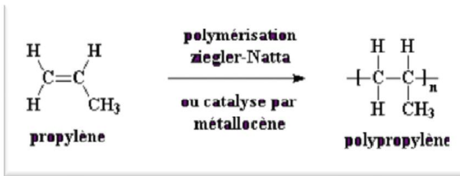
Figure 4 : Schéma représentatif de la réaction de polymérisation du propylène.
