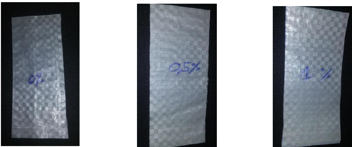
Film à 0% du pro-oxydant. Film à 0.5% du pro-oxydant. Fils à 1% du pro-oxydant.
