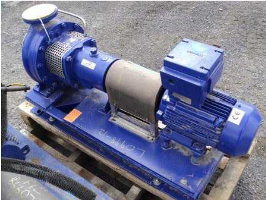
Figure III.4 : Pompe CPKN-S du site SP2. [16]
