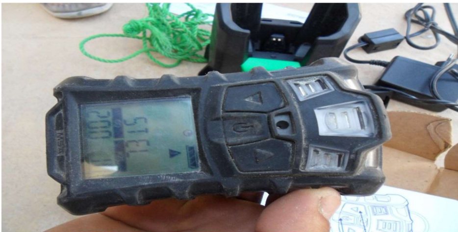
Fig. (5)III.05 : L'appareil de détection en H 2 S
