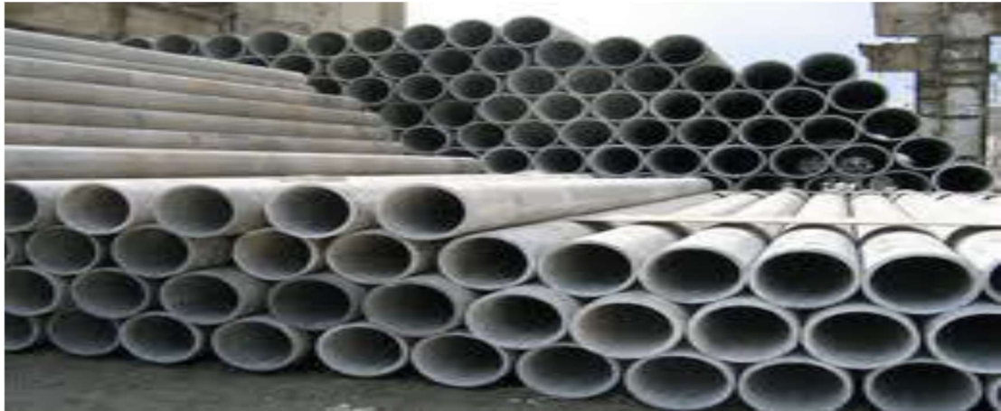
Fig. 1.09 : Conduite en amiante ciment.
