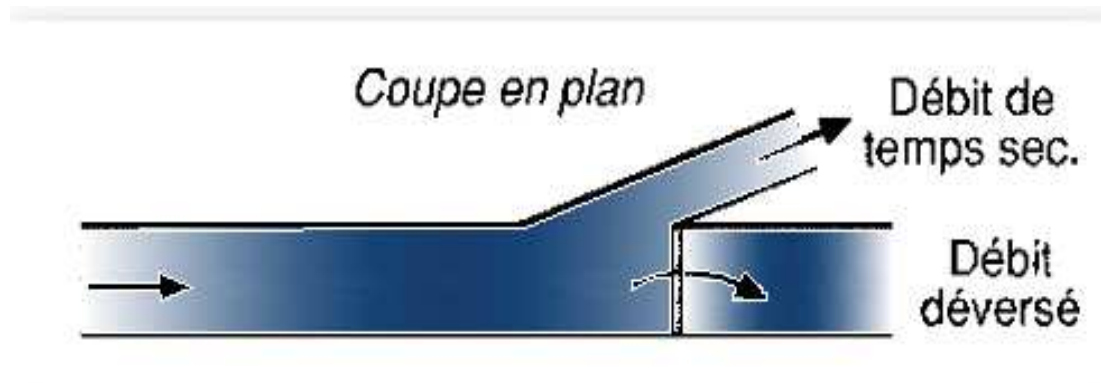
Figure II-4 : Déversoir à seuil frontal.
