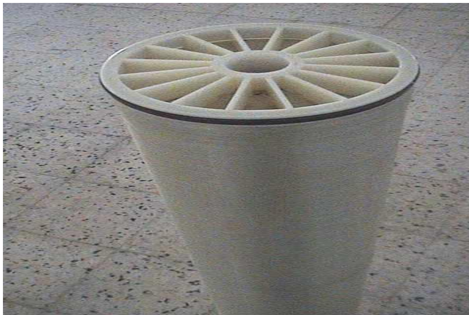
Figure III.7 : Face externe d'un module d'osmose inverse utilisée au niveau de Cevital.
