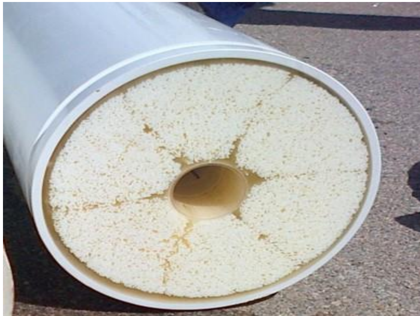
Figure III.2: Schéma d'une membrane organique [15]
