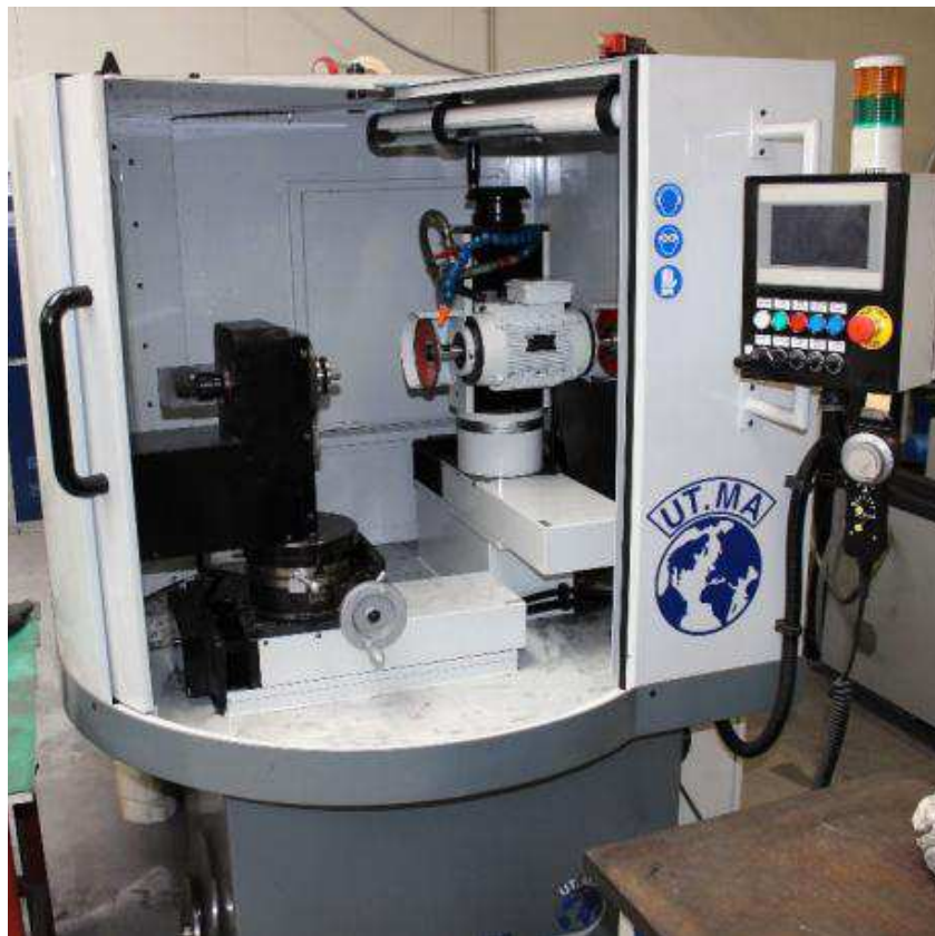
Figure I.6: modèle d’une affuteuse à commande numérique [8]
