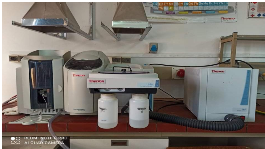
Figure III. 10 : Spectrophotomètre à absorption atomique utilisée de marque Thermo SCIENTIFIC (iCE3000 SERIES).
