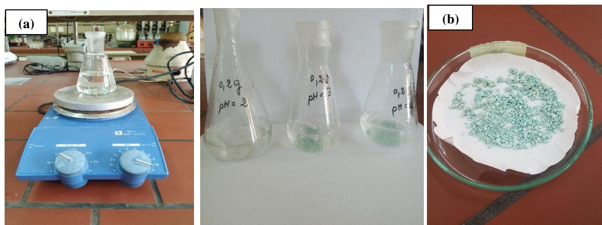
Figure III. 9 : Dispositif expérimental utilisé pour les essais d'adsorption (a) et les billes obtenues après adsorption (b).
