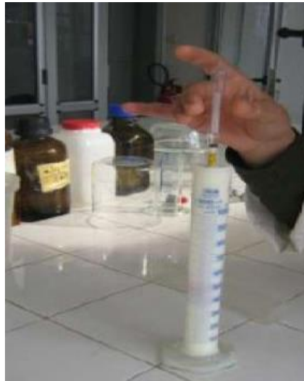
Figure II. 2 : Mesure de densité avec lactodensimètre
