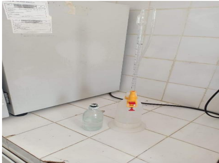
Figure II. 5 : Mesure d'acidité titrable
