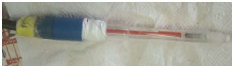
Figure.II.4. Schéma d'une électrode au calomel saturé
