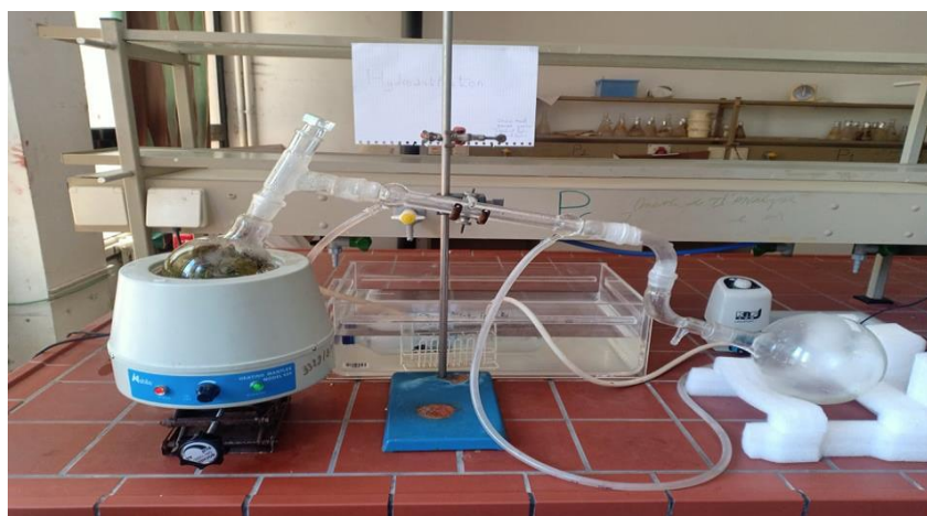
Figure 19 : Dispositif expérimental de l'hydrodistillation
