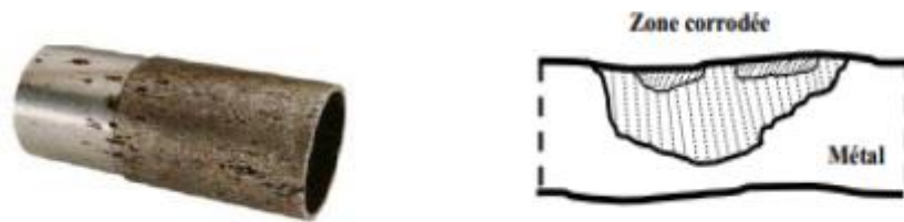
Figure I.15 : Corrosion par piqures
