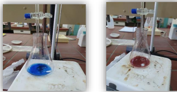
Figure N°29 : Titration du mélange fehling avec le filtrat.
